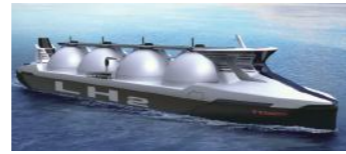
開発中の大型液化水素運搬船 川崎重工業が実用化を目指しているタンカー規模の液化水素運搬船。貨物積容積4万m 3 ×4基。
