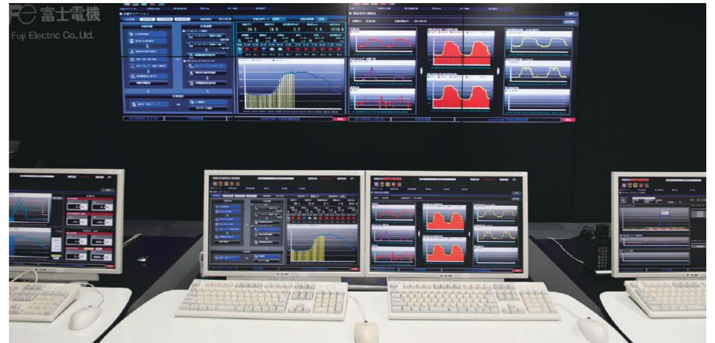
スマコミのコンセプトであるエネルギーシェアをコントロールする「地域節電所」。気象情報や過去データをもとに翌日の需要予測を作成
