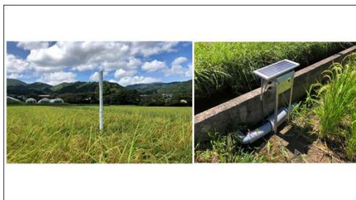
水田センサーと自動水門装置
